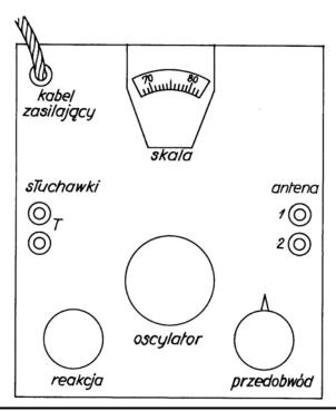
Kabel zasilający Mains lead Antena Aerial socket Skala Tuning scale Słuschawki Headphones sockets Reakcja Reaction control Oscylator Tuning control Przedobwód Preselector tuning Text translation of functions of controls OSU receiver.
